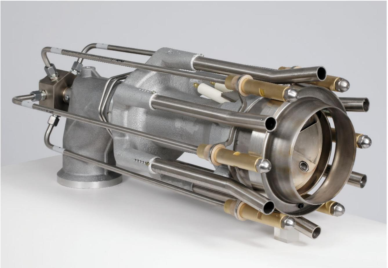
**La technologie brevetée multiflam® permet d'obtenir des valeurs d'émissions réduites sur des installations de grandes puissances sans investissement complémentaire. La réduction des émissions d'oxyde d'azote est obtenue grâce à une chambre de mélange innovante qui utilise le principe de la combustion étagée.**
