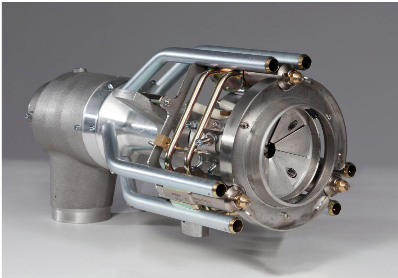
**La technologie brevetée multiflam<sup>®</sup> permet d'obtenir des valeurs d'émissions réduites sur des installations de grandes puissances sans investissement complémentaire. La réduction des émissions d'oxyde d'azote est obtenue grâce à une chambre de mélange innovante qui utilise le principe de la combustion étagée.**
